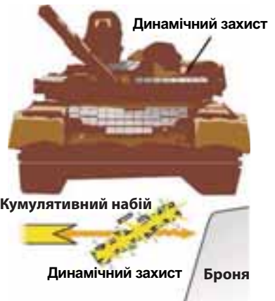
Розміщення та функції динамічного захисту
