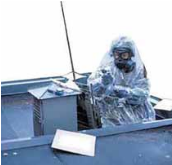
Індикація забруднення повітря за допомогою ручної помпи та індикаторного піддона.
