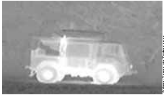
Позашляховик, який бачимо через оптичний приціл (тепловізор- / пасивний ІЧ). Темне поле на верхній лівій частині позашляховика пофарбовано, що вбирає ІЧ
